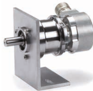
带EQN 400的安装架组件 最大轴载荷： 轴向 150 N 径向 350 N
